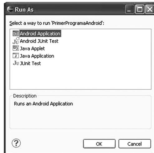
Figura 10. Ventana para ejecutar la aplicación Android
