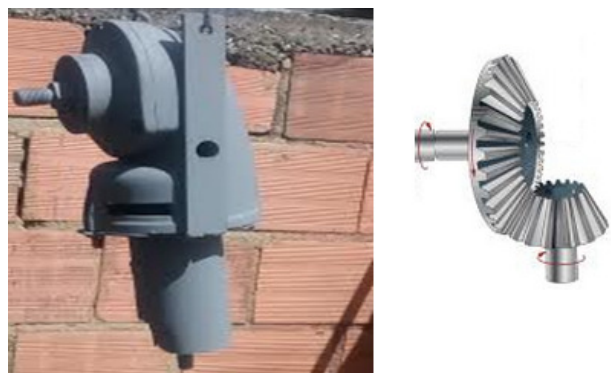
Figura 5. Multiplicador de velocidad (1000 W) de engranes Hipode con dentado recto (González, Río, Tena, y Torres, 2011).
