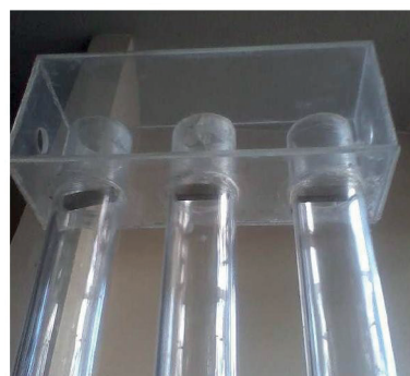
Figura 4. Diseño de la planta de levitación neumática: caja superior de la estructura. Se detalla la conexión de los tres tubos. Fuente: elaboración propia.
