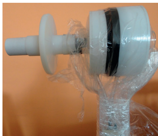
Figura 8. Boquilla desechable, filtro bacteriológico y neumotacógrafo tipo Lilly. Fuente: elaboración propia.
