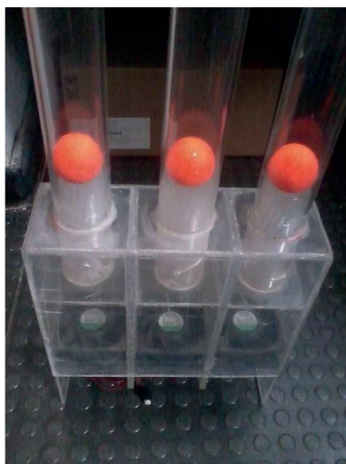
Figura 3. Diseño de la planta de levitación neumática: caja inferior de la estructura. Se detallan los tres ventiladores y la forma en que interactúan con las pelotas de cada tubo. Fuente: elaboración propia.
