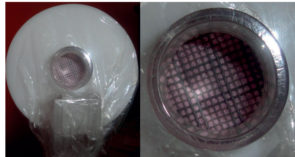
Figura 5. Resistencia neumática en el neumotacógrafo tipo Lilly. Fuente: elaboración propia.
