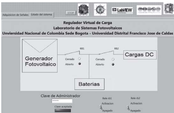
Figura 5. Panel frontal del regulador virtual de carga, pestaña "Estado del sistema"
