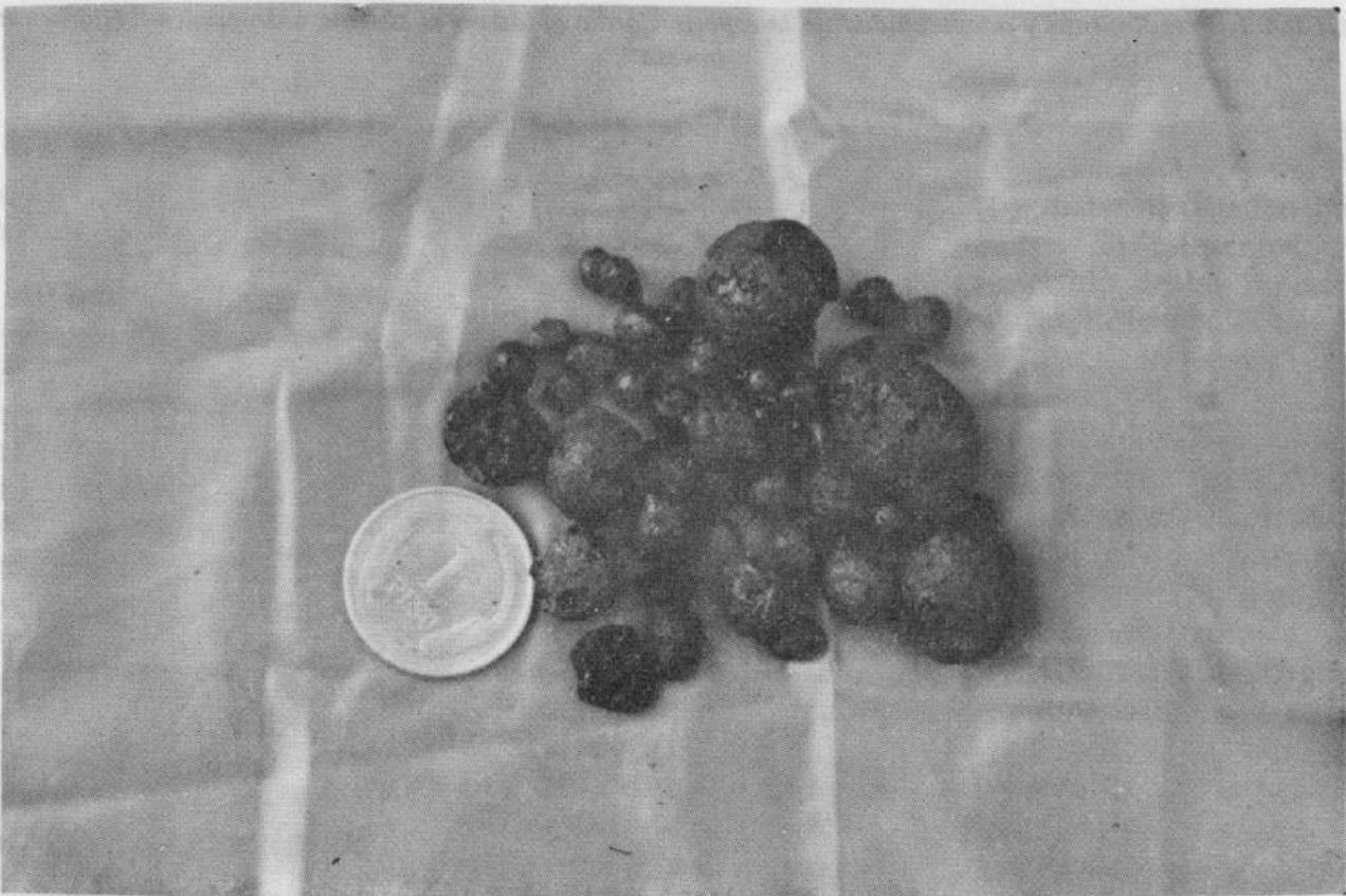
FIGURA 4. Arcilla expansiva (Herculita) que sirve de sustrato al sistema hidropónico "Hidroculture luwasa". Químicamente inerte. Granulometría 8 a 20 mm.
