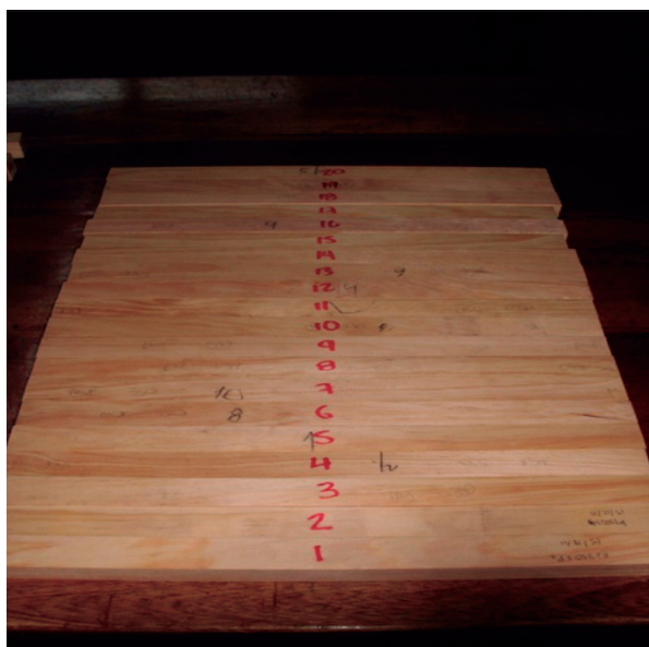
Figura 3. Probetas de flexión estática de P. caribaea enumeradas después del tiempo de fraguado para posteriormente ser falladas en la máquina universal
