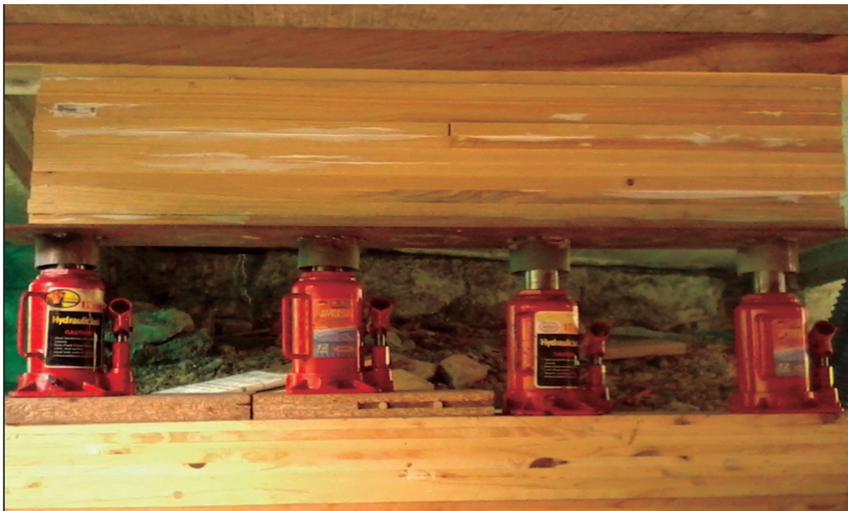
Figura 1. Proceso de prensado de la MLE. Se usaron cuatro gatos hidráulicos cada uno con una capacidad de 12 t
