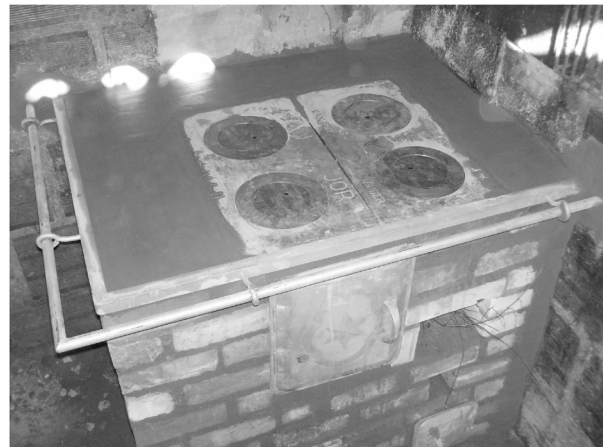
Figura 3. Prototipo de la estufa mejorada.
