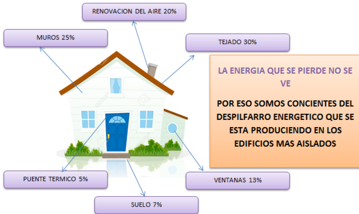
Figura 2. Pérdida de energía en una edificación
