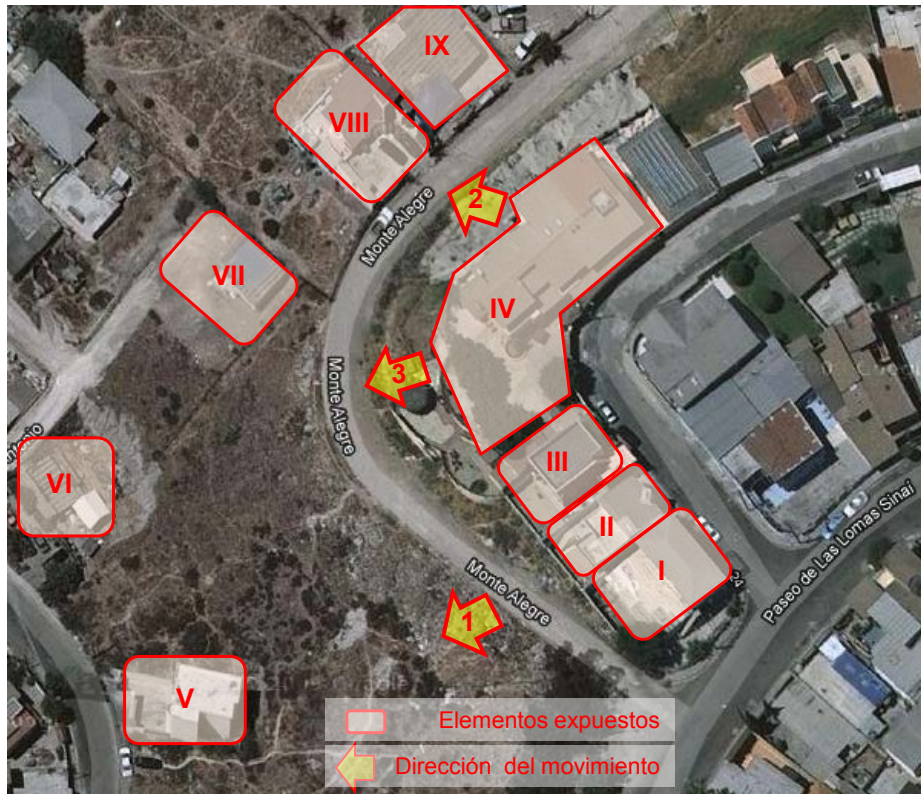
Figura 10. Elementos susceptibles a sufrir daños por los movimientos de la ladera
