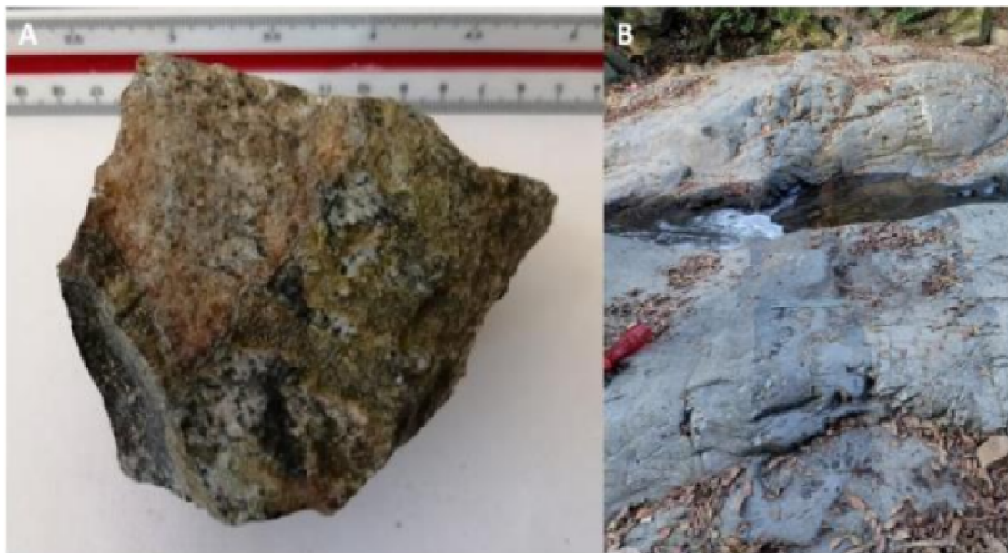
Figura 4. A. Granito (textura fanerítica). B. Aflorando en la cuenca alta del Río Guatapurí, presencia de diques de composición máfica de 40 cm a 50 cm de espesor
