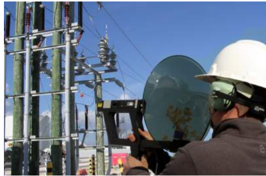
Figura 7. Detección de descargas parciales por ultrasonido
