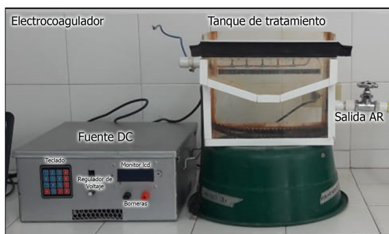
Figura 1. Montaje del electrocoagulador tipo Bach con electrodos monoplares conectados en paralelo
