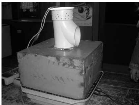
Figura 9. Montaje realizado para la medición de los parámetros eléctricos con respecto a la temperatura
