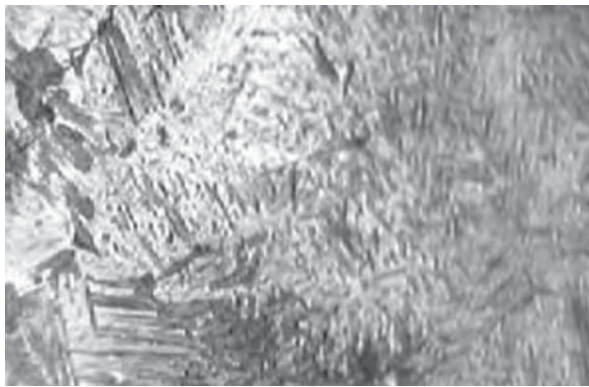
Figura 13. Martensita de temple incompleto, aumento 400x.
