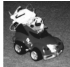
FIGURA 16. Robot para Solución de Laberintos Adaptado a partir de un Juguete Mecánico
