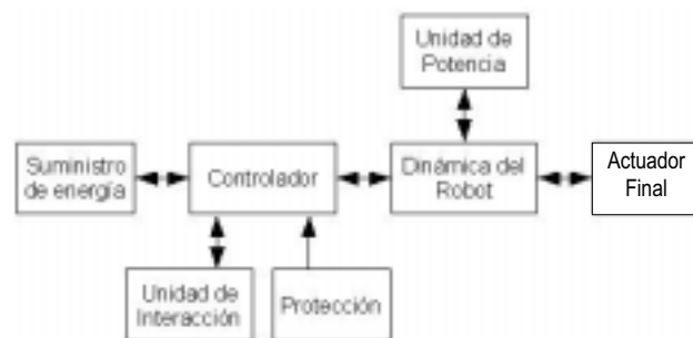
FIGURA 13. Diagrama de bloques de un robot
