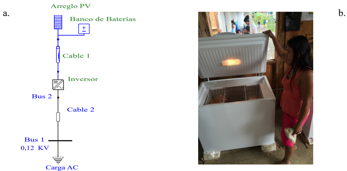
Figura 1. a. Diagrama unifilar de la escuela. b. Unidad componente del sistema de refrigeración
