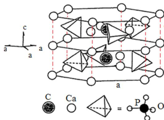
Figura 1. Estructura cristalina de la hidroxiapatita [7]
